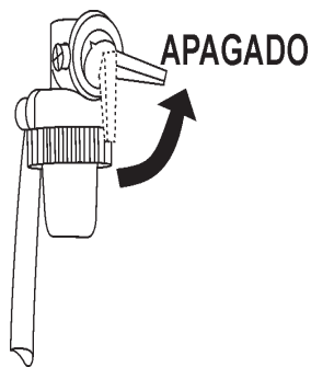
Figura 25. Palanca de la válvula de combustible del motor (Posición OFF APAGADO)
