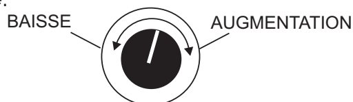
Figure 9. Bouton de Commande du Régulateur de Tension
