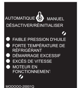
Figure 29. Moteur en Marche DEL (ACTIVÉ)
