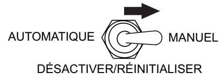
Figure 28. Commutateur de Commande MPEC (Position Manuelle)
