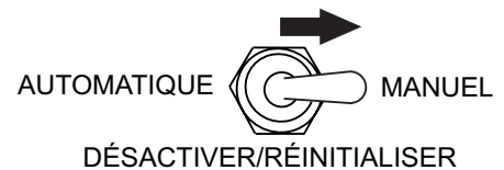
Figure 28. Commutateur de Commande MPEC (Position Manuelle)
