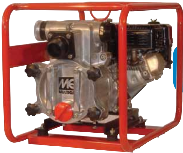
Modelo QP4TH 4X4 hasta 555gpm Motor Honda de 9.5hp Maneja sólidos hasta 2 pulgadas
