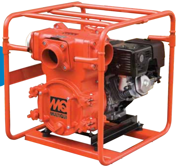
Modelo QP4TH 4X4 hasta 555gpm Motor Honda de 9.5hp Maneja sólidos hasta 2 pulgadas
