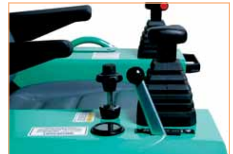
Control de velocidad de rotores, este dispositivo le permite al operador fijar la velocidad de los rotores a una velocidad constante sin tener que presionar el control de pedestal constantemente, reduciendo la fatiga que representa operar a bajas revoluciones
