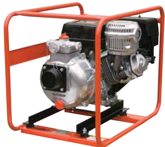
QPT305SLT 3" Suction - 142 psi. 145 GPM - 328' HEAD
