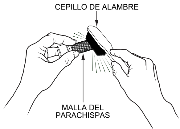
Figura 57. Limpieza del parachispas
