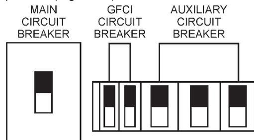
**Figure 53. Main, Aux. and GFCI Circuit Breakers (ON)**
