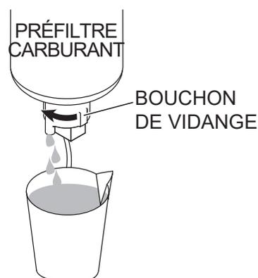
**Figure 40. Filtre séparateur d'eau et de carburant**
