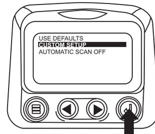
10. Utilisez les **touches fléchées** pour faire défiler et mettre en surbrillance un paramètre sélectionné (paramètre avec un symbole # à sa droite).
