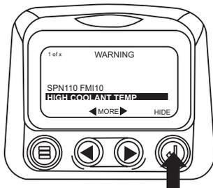
7. L'écran à un ou quatre paramètres affiche l'icône de Panne jusqu'à ce que la condition de Panne soit corrigée. **REMARQUE** : Le fait de ne pas tenir compte des codes d'erreur actifs peut entraîner de graves dommages au moteur ou à la machine.
