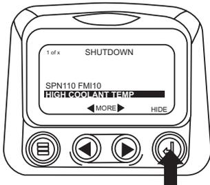
6. L'écran des paramètres Single ou Four affiche l'icône de Panne jusqu'à ce que la condition de Panne soit corrigée. **REMARQUE** : Le fait de ne pas tenir compte des codes d'erreur actifs peut entraîner de graves dommages au moteur ou à la machine.
