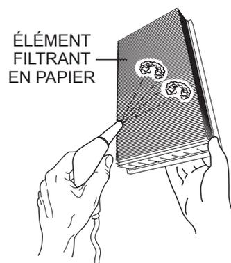
**Figure 25. Nettoyage du filtre en papier intérieur**
