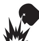
Lors de la connexion du côté positif (+) du câble à la borne positive (+) de la batterie **NE PAS** laisser la clé ou toute autre pièce métallique entrer en contact avec la borne négative (-) de la batterie. Cela peut provoquer un court-circuit électrique ou une explosion.
