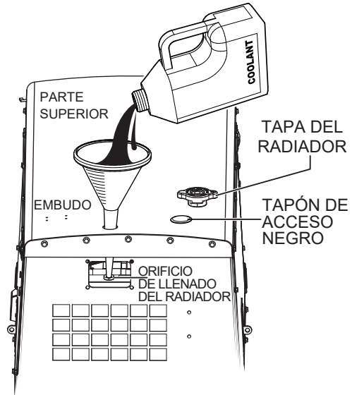
Figura 32. Adición de refrigerante
