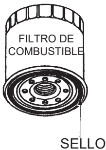
Figura 26. Filtro de combustible
