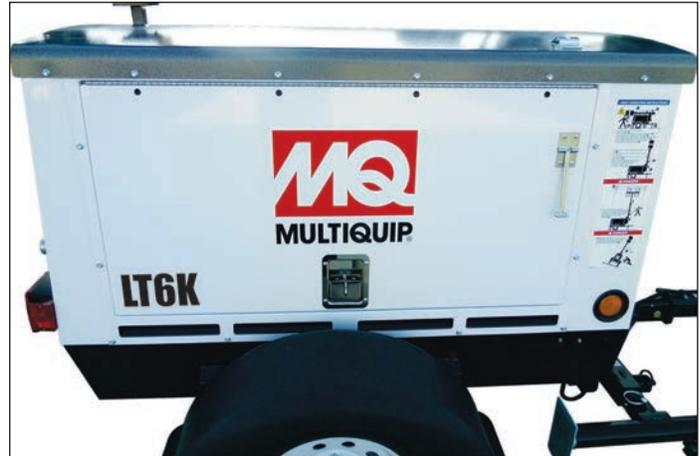
Facilidad de las operaciones del panel de control, el mantenimiento programado y la capacidad de servicio mediante puertas de acceso de gran tamaño (50,8 cm x 104,1 cm [20" x 41"]) con manija de la puerta con llave y pestillos de bloqueo del capó.
