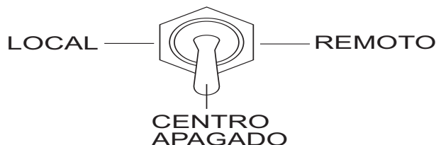
Figura 21. Interruptor de control de bombeo (OFF APAGADO)
