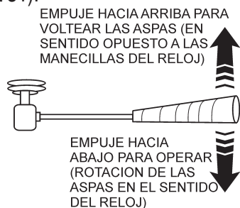
Figura 31. Palanca de control de la revoladora de la tolva
