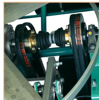
Des joints homocinétiques du genre automobile assurent le transfert continu de la puissance à chaque boîte de vitesses. Le transporteur à courroie, commodément situé sur l'arbre, fournit les courroies trapézoïdales de secours, au cas où l'une se briserait.
