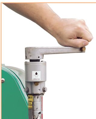
La commande TwinPitch brevetée, disponible sur tous les modèles, permet à l'opérateur de contrôler simultanément la hauteur des deux rotors avec un effort minimal.
