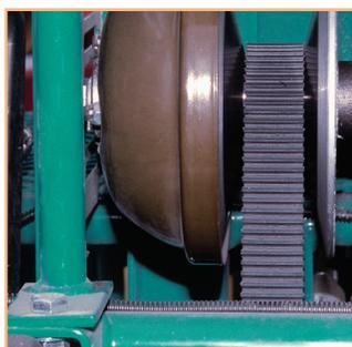
La transmission à variation continue (CVT) fournit des performances supérieures en ajustant le rapport d'entraînement pour obtenir le couple optimum et les niveaux de vitesse au cours du lissage et du finissage à grande vitesse.
