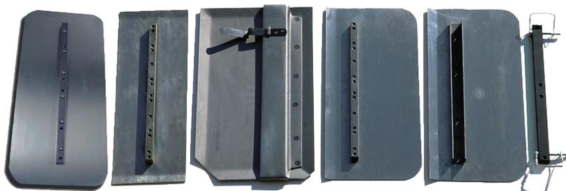
As pás MQ Whiteman são feitas de aço de ferramenta com tratamento térmico formulado segundo as nossas especificações, para a máxima resistência ao desgaste e longa vida útil. As nossas pás são produzidas com rebites adicionais, que conferem uma maior uniformidade e resistência à torsão. Deste modo, aumenta a estabilidade da máquina, que produz um acabamento mais polido e plano.
