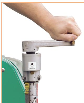
O comando TwinPitch patenteado, disponível em todos os modelos, permite que o operador comande simultaneamente o passo dos dois rotores com o mínimo esforço.
