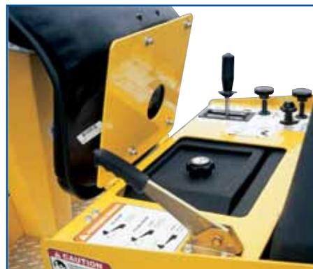
Tanque de combustible de polietileno de 9.5 galones con mirilla de nivel de combustible incorporado, ubicado debajo del asiento del operador para fácil acceso, funcionamiento de hasta 6.5 horas.
