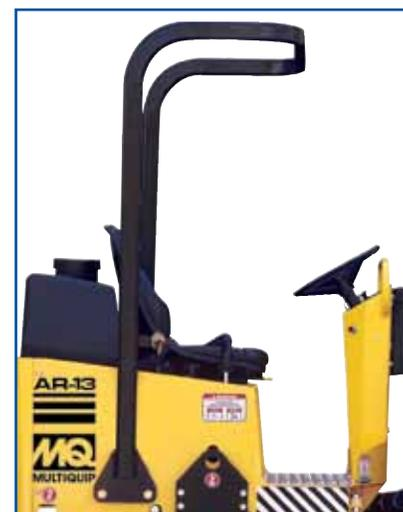
ROPS (protección por volcadura) incrementa la seguridad del operador, característica estándar en el modelo AR13.
