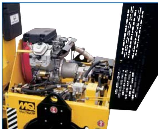
Cubierta de acceso al motor- sencillo y fácil acceso al los componentes del motor
