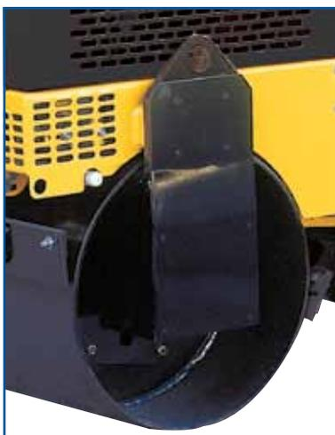
Motores y mangueras hidráulicas ubicadas en el lado izquierdo, totalmente protegidas para educir probabilidades de daños
