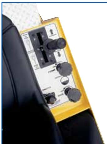
Mandos agrupados. Los mandos de avance, acelerador y válvulas de flujo de agua están convenientemente ubicados a lado derecho del operador para fácil operación y permite una dosificación precisa de agua en los dos rodillos. El encendido de la vibración esta ubicado la palanca de avance.
