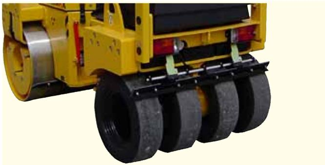
Kombo serie (K) estos modelos con ruedas posteriores de hule en vez de un rodillo de acero, reduce la probabilidad de daños de un tambor de acero sobre la superficie de la capa asfáltica.
