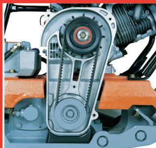
**Ventilador integrado con la polea del embrague** - enfría el flujo del aire para mayor vida útil de la correa.
