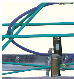
Os vibradores pneumáticos em bronze naval resistem à corrosão e fornecem vibrações de alta frequência.
