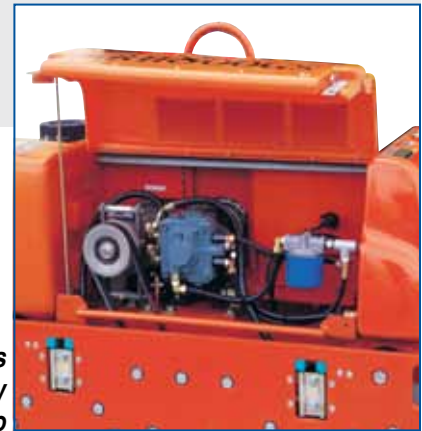
Fácil acceso a los componentes internos y filtro hidráulico
