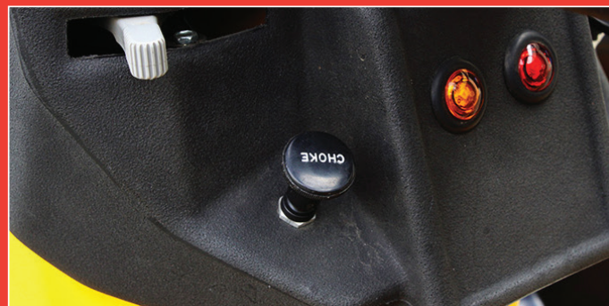
El panel cuenta con control de acelerador deslizante, dos luces indicadoras, estrangulador integrado y encendido a prueba de agua.
