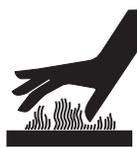
Los componentes del motor pueden generar calor extremo. Con el fin de prevenir quemaduras, **NUNCA** toque estas áreas mientras el motor esté funcionando o inmediatamente después de pararse. **NUNCA** utilice la allanadora sin silenciador.
