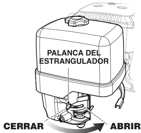
Figura 23. Palanca del estrangulador (Abierto)
