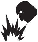
**NUNCA** use gasolina o solventes de bajo punto de inflamación para limpiar el motor o cualquiera de sus componentes. Existe peligro de **incendio** o **explosión**, que puede dañar el equipo y causar **lesiones corporales graves** e incluso la **MUERTE**.
