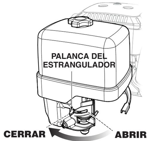
Figura 22. Palanca del estrangulador (Cerrado)
