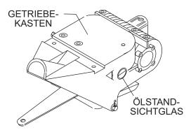
Abbildung 7. Getriebekasten
