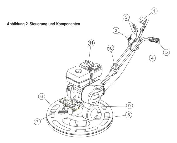
Abbildung 2 zeigt die Anordnung der grundlegenden Bedienelemente oder Komponenten des *CA4HM-GLÄTTERS*. Alle Bedienelemente oder Komponenten sind nachstehend kurz beschrieben
