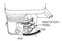
Abbildung 8. Kraftstoffventilhebel des Motors
