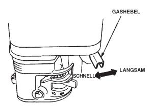
Abbildung 14. Gashebel (Betriebsstellung)
