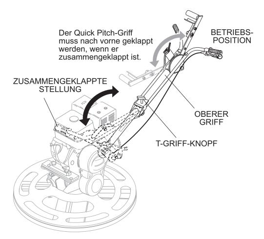
Abbildung 4. Eingeklappter Glätter und Bedienpositionen
