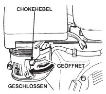
Abbildung 10. Chokehebel des Motors
