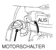
Abbildung 15. EIN/AUS-Schalter des Motors (Stellung AUS)
