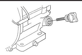
Abbildung 5. Motorölmessstab (Ausbau)
