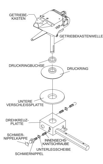
Abbildung 24. Drehkreuz-/Getriebekastenausbau
