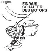
Abbildung 12. EIN/AUS-Schalter des Motors
