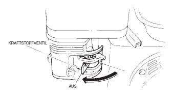
Abbildung 16. Kraftstoffventilhebel (Stellung AUS)
