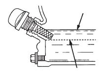
Abbildung 6. Motorölmessstab (Ölstand)
