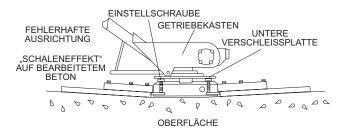
Abbildung 22. Abgenutzte Drehkreuzplatte
