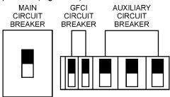
Figure 52. Main, Aux. and GFCI **Circuit Breakers (ON)**
