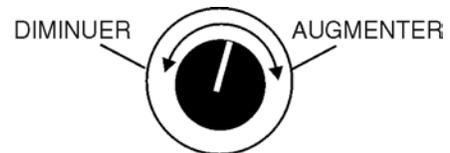
Figure 47. Bouton de commande de réglage de tension
