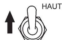
**Figure 28. Interrupteur de régime moteur (haut)**
