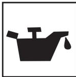
Si ce témoin est allumé (**ON**) pendant le fonctionnement normal du générateur, le système d'arrêt d'urgence arrêtera automatiquement le moteur.
