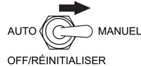
**Figure 42. Interrupteur manuel d'arrêt/réinitialisation automatique (position manuelle)**
