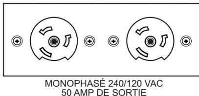
Figure 8. Réceptacles auxiliaires à verrouillage tournant 240/120V
