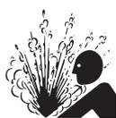
Si vous ajoutez un mélange de liquide de refroidissement et d'antigel au radiateur, **NE retirez PAS** le bouchon du radiateur avant que l'appareil n'ait complètement refroidi. Il est possible que le liquide de refroidissement soit **chaud**, ce qui peut provoquer de graves brûlures.
