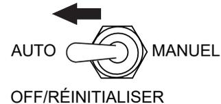
**Figure 52. Interrupteur manuel d'arrêt/réinitialisation automatique (AUTO)**
