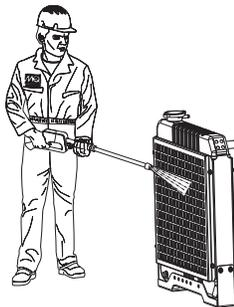
Figure 67. Nettoyage des radiateurs
