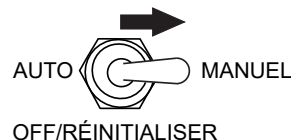
Figure 42. Interrupteur manuel d'arrêt/réinitialisation automatique (position manuelle)
