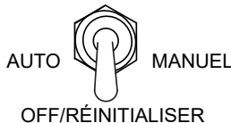
Figure 54. Interrupteur manuel d'arrêt/réinitialisation automatique (Off/Reset)
