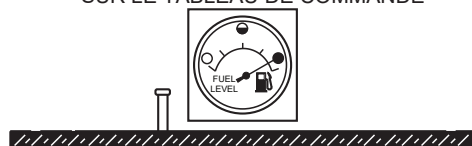
Figure 33. Réservoir de carburant plein
