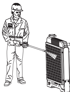
Figure 67. Nettoyage des radiateurs
