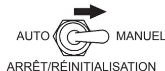
**Figure 43. Commutateur de commande MPEC (Position manuelle)**
