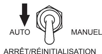
**Figure 58. Commutateur de commande MEPC
