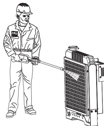
**Figure 81. Nettoyage des radiateur**
