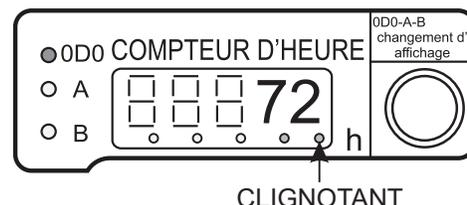
**Figure 32. Compteur horaire (démarrage du moteur)**
