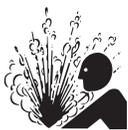
**NE PAS** retirer le bouchon de pression du radiateur lorsque le moteur est chaud! Attendre que la température du liquide de refroidissement soit inférieure à 50 °C (120 °F) avant de retirer le bouchon de pression.
