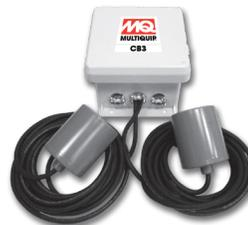
Todas las bombas MQ 115V 1Ø han sido diseñadas con una protección contra sobrecarga térmica interna y no requieren una protección eléctrica adicional; sin embargo, se ofrece la **Caja de control CB3** para operaciones convenientes de ON/OFF/AUTO (encendido, apagado, automático) y del interruptor de flotador. La CB3 viene con dos interruptores de flotador SW1WOPA.
