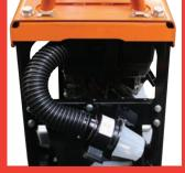
Prefiltro ciclónico: reduce notablemente la frecuencia del mantenimiento y prolonga la eficiencia máxima del motor.
