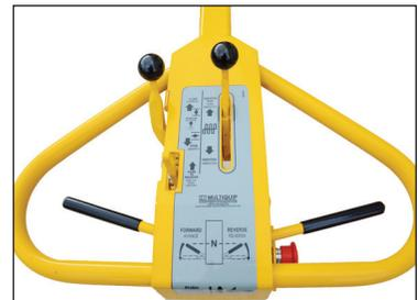
El asa multifuncional controla la marcha hacia adelante y en reversa, el flujo de agua al tambor, la vibración y la función de parada de emergencia.
