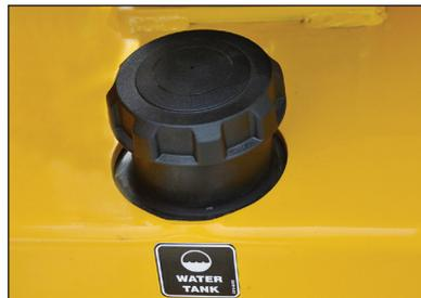
El tanque de agua de plástico pendiente de patente elimina las obstrucciones en el flujo de agua y evita la acumulación de óxido.
