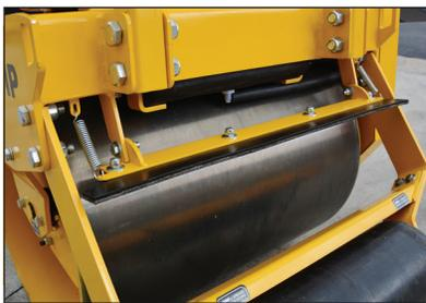
La barra raspadora accionada por resortes se pliega para facilidad de cambio y limpieza.
