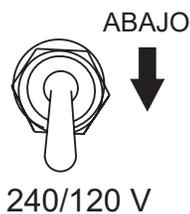
**Figura 24. Posición de 240/120 V del interruptor de plena potencia (hacia abajo)**
