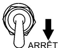
**Figure 19. Commutateur de commande du ralenti (ARRÊT)**
