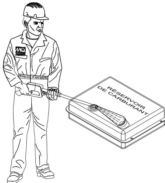
Figure 42. Nettoyage du réservoir de carburant
