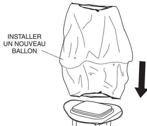
**Figure 42. Remplacer le ballon**
