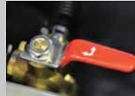
Válvula de tres vías disponible para cambiar al tanque de combustible externo
