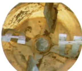
**Las mezcladoras de tambor de polietileno se limpian rápida y fácilmente.** En estas imágenes se muestra hormigón que se dejó secar más de 24 horas. Con pocos golpes de un mazo, casi todo el material seco se desprende de la mezcladora. ¡De verdad es así de sencillo limpiarlas!
