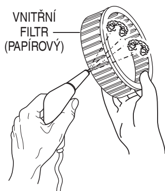
Obrázek 18. Čištění vnitřní papírové filtrační vložky
