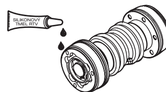
Obrázek 29. Nanesení silikonového tmelu RTV
