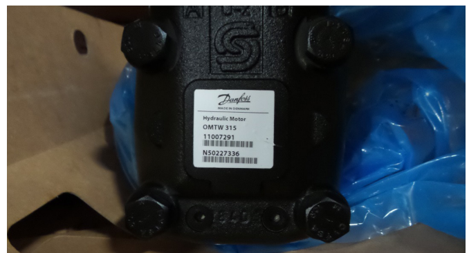
Figure 4. Emplacement du numéro de série du moteur
