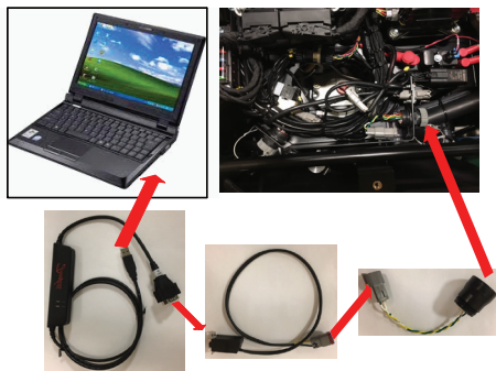
Figure 16. Connexion de l'ordinateur portable
