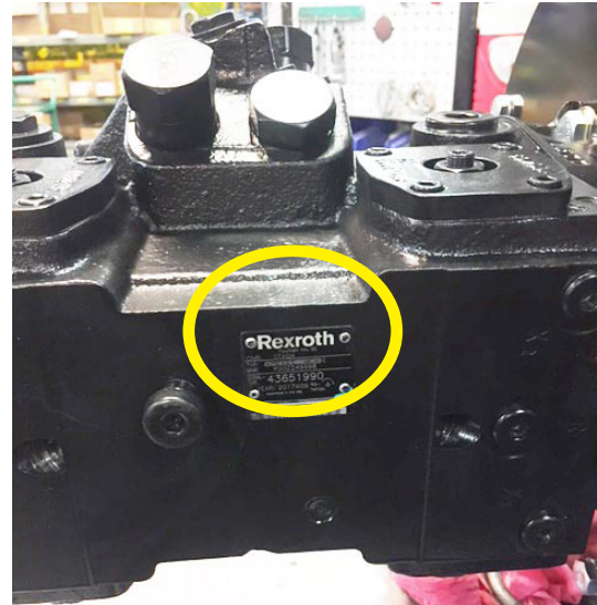
Figure 3. Emplacement du numéro de série de la pompe
