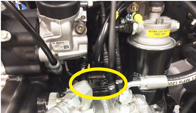
Figure 1. Emplacement de l'étiquette de série du moteur
