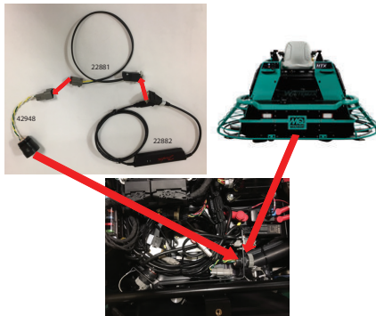
Figure 14. Câble de la passerelle CAN vers le port de service
