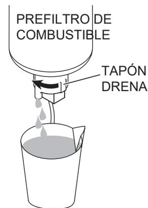
**Figura 40. Filtro del separador de agua y combustible**
