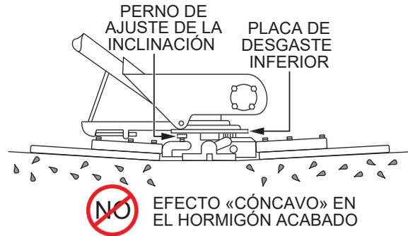
**Figura 61. Hojas inclinadas hasta una posición plana (incorrecta)**
