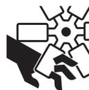
No coloque **NUNCA** las manos ni los pies dentro del anillo de protección con el motor en marcha.. Apague **SIEMPRE** el motor antes de efectuar cualquier servicio de mantenimiento en la alisadora.
