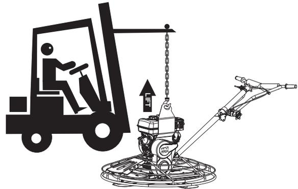
Figura 26. Elevación de la alisadora
