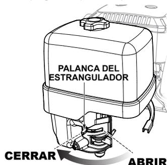
Figura 9. Palanca del estrangulador
