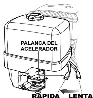
Figura 10. Palanca del acelerador
