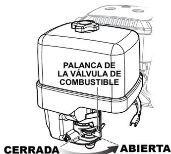
Figura 8. Válvula de corte de combustible
