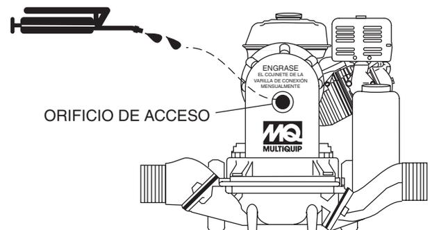
Figura 8. Lubricación del cojinete de la varilla de conexión
