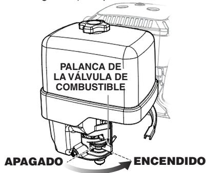
**Figura 9. Palanca de la válvula de combustible del motor (posición de encendido)**
