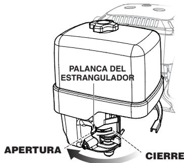
**Figura 11. Palanca del estrangulador del motor (cerrada)**
