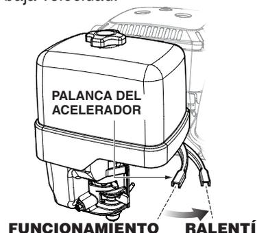
**Figura 17. Palanca del acelerador (ralentí)**
