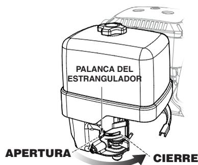
**Figura 15. Palanca del estrangulador (abierta)**
