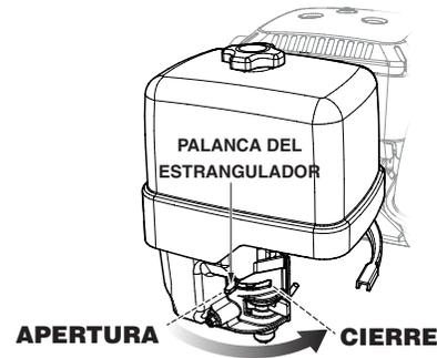
**Figura 12. Palanca del estrangulador del motor (abierto)**
