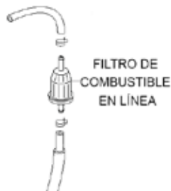
Figura 12. Filtro de combustible en línea
