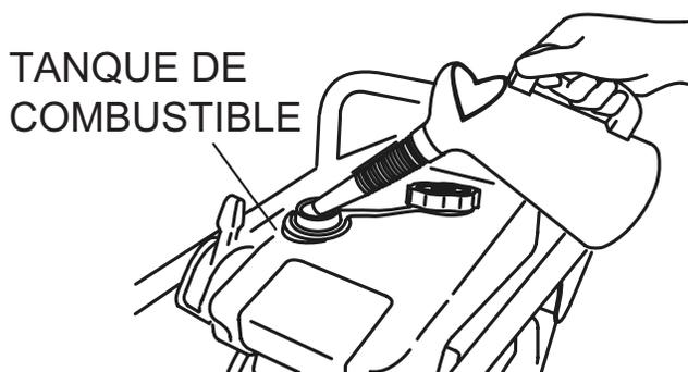
Figura 4. Tanque de combustible
