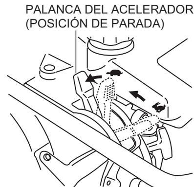
**Figura 11. Palanca del acelerador (posición de parada)**
