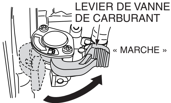
Figure 10. Levier de la soupape de carburant
