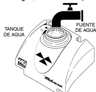
**Figura 6. Llenado del tanque de agua**
