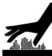
Los componentes del motor pueden generar calor extremo. Para evitar quemaduras, **NO** toque estas áreas mientras el motor esté en marcha o inmediatamente después. **NUNCA** haga funcionar el motor sin el silenciador.
