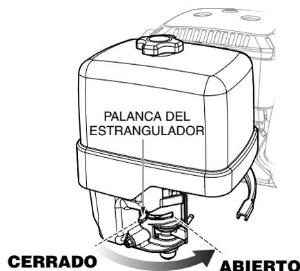
Figura 14. Palanca del estrangulador del motor (abierto)
