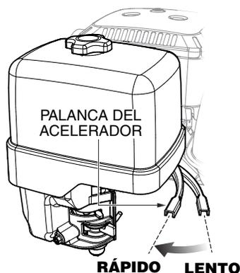
Figura 13. Palanca del acelerador (1/3 de la posición de arranque)
