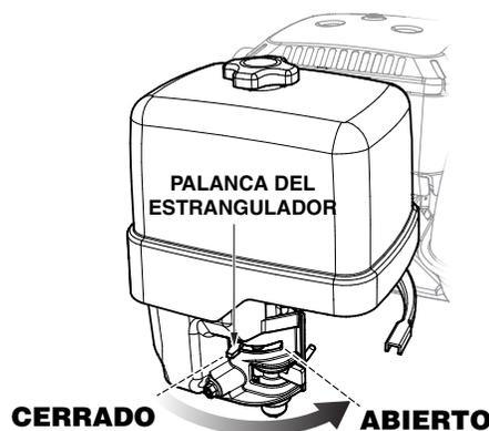
**Figura 18. Palanca del estrangulador (abierta)**
