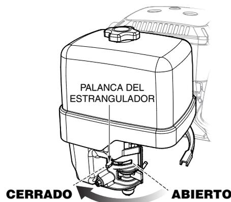
Figura 15. Palanca del estrangulador (cerrada)
