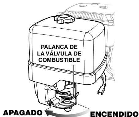
**Figura 23. Palanca de la válvula de combustible (apagada)**
