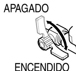
**Figura 19. Válvula de agua (encendida)**
