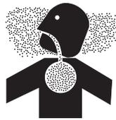
Tal vez sea necesario hacer funcionar el motor para algunas operaciones de mantenimiento. Asegúrese de que el área de mantenimiento esté bien ventilada. Los gases de escape del motor de gasolina contienen monóxido de carbono venenoso que puede provocar desmayos y la **MUERTE**.
