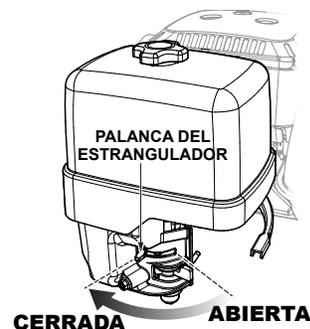
Figura 14. Palanca del estrangulador (Cerrada)
