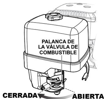
**Figura 24. Palanca de la válvula de combustible (CERRADA)**
