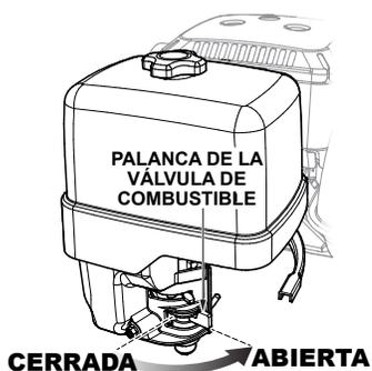
Figura 12. Palanca de la válvula de combustible del motor (posición ABIERTA)
