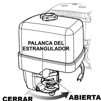
Figura 18. Palanca del estrangulador (abierta)
